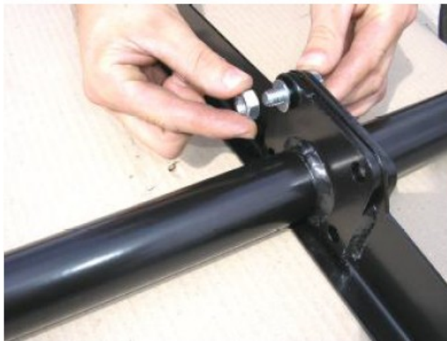
11: Skru de forreste trækstang styrke bolte. Tilspændingsmoment er 62 Nm. Når du installerer akslen, være omhyggelig med at beskadige kablet.
