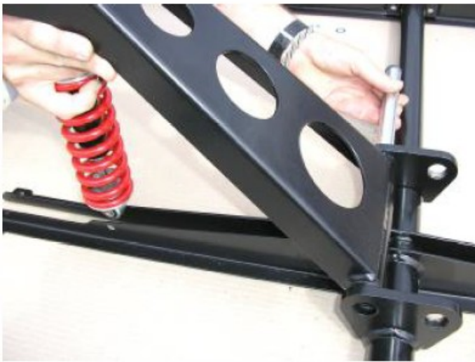
3: Installer drivakslen til chassiset mounts og bolthuller gennem drivakslen pr. 20 mm Gentaag med det andet drev aksel
