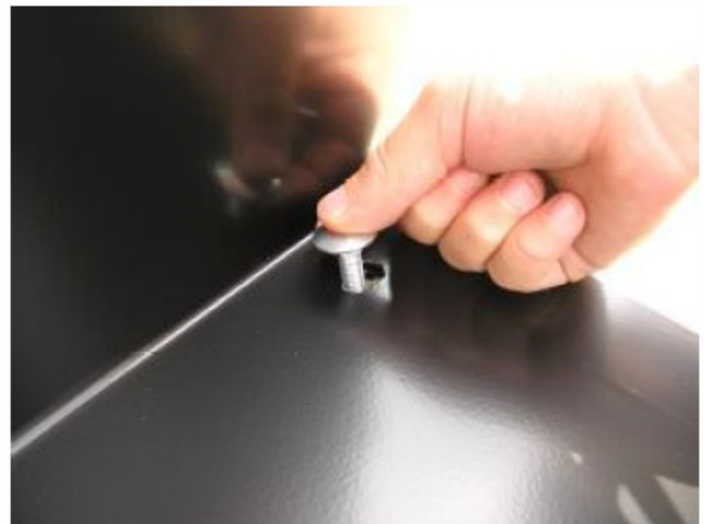
12: Chassis drej hjulene og sat på bagsiden af rammen, så huller i kabinettet flugter med hullerne i lastbil seng. Skru bagsiden af individuelle dør bolte.
