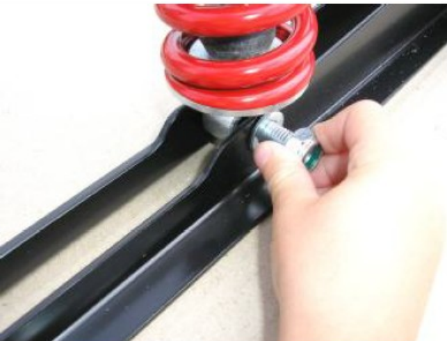
5: Bjælker til skroget på begge sider af chassiset, skrue stød styrke bolte M10 x 50 (40) med skive og låsemøtrikken.
