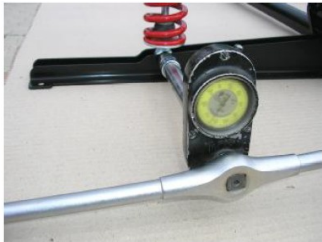
6: Stramning udføre på begge sider af chassiset momentnøgle til torsion 62 Nm
